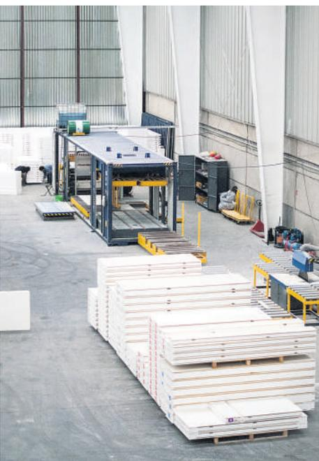
Les panneaux sont constitués de deux plaques composées principalement de magnésium, de fibre de verre et de polystyrène expansé. L'entreprise a repris dans la fabrication des panneaux une formule utilisée par le gouvernement chinois pour isoler les dépôts de munitions (Ph. Natalia Gaia)
