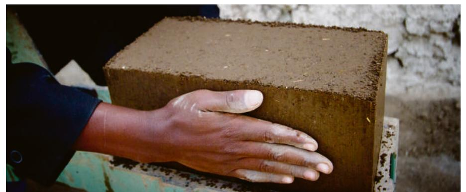
Depuis 2013, près d'une douzaine de machines manuelles à presser les blocs ont été distribuées aux alentours de la ville de Mbeya, en Tanzanie, ainsi qu'au Rwanda, au Cameroun et en Zambie. Ces machines produisent des briques ne nécessitant aucune cuisson, à base de terre, de sable et de ciment (Ph. Jacob Kushner)
