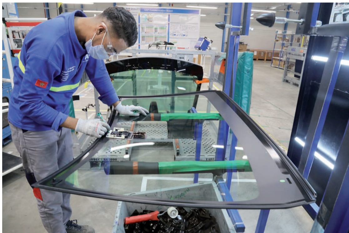
Au-delà du vitrage, le pare-brise AGC intègre plusieurs éléments ergonomiques, des capteurs, des câbles...
