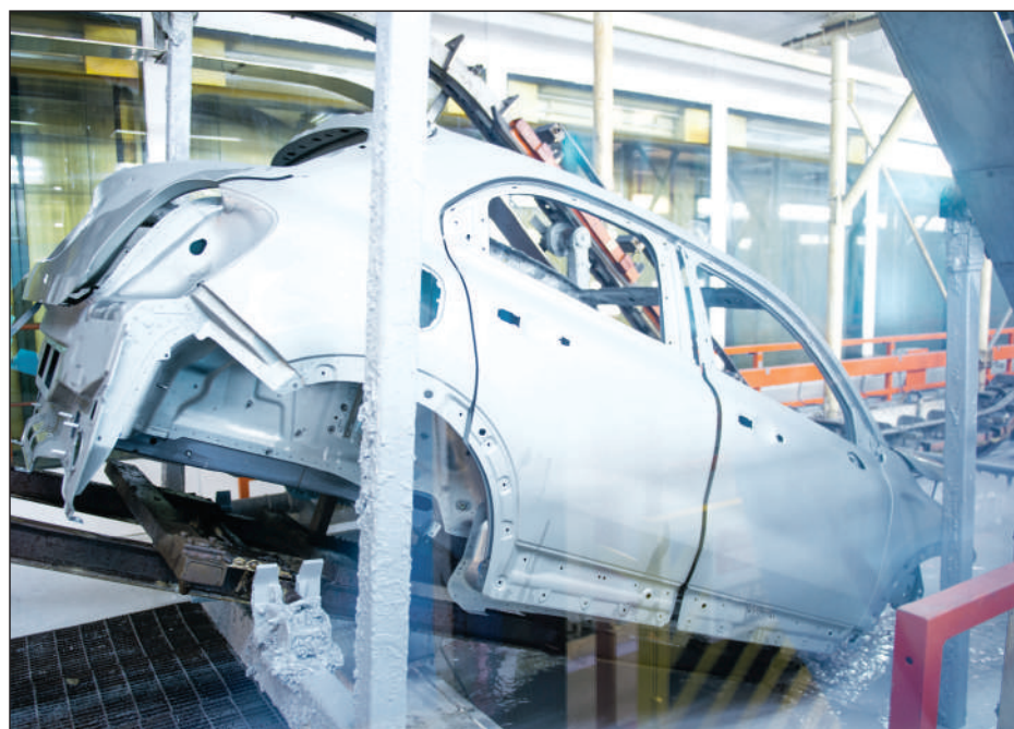
Une fois assemblée, la coque doit faire un bain. Un bain bien spécial, puisqu'elle est trempée dans un liquide anticorrosion avant de recevoir une teinte (Ph. FCA)
