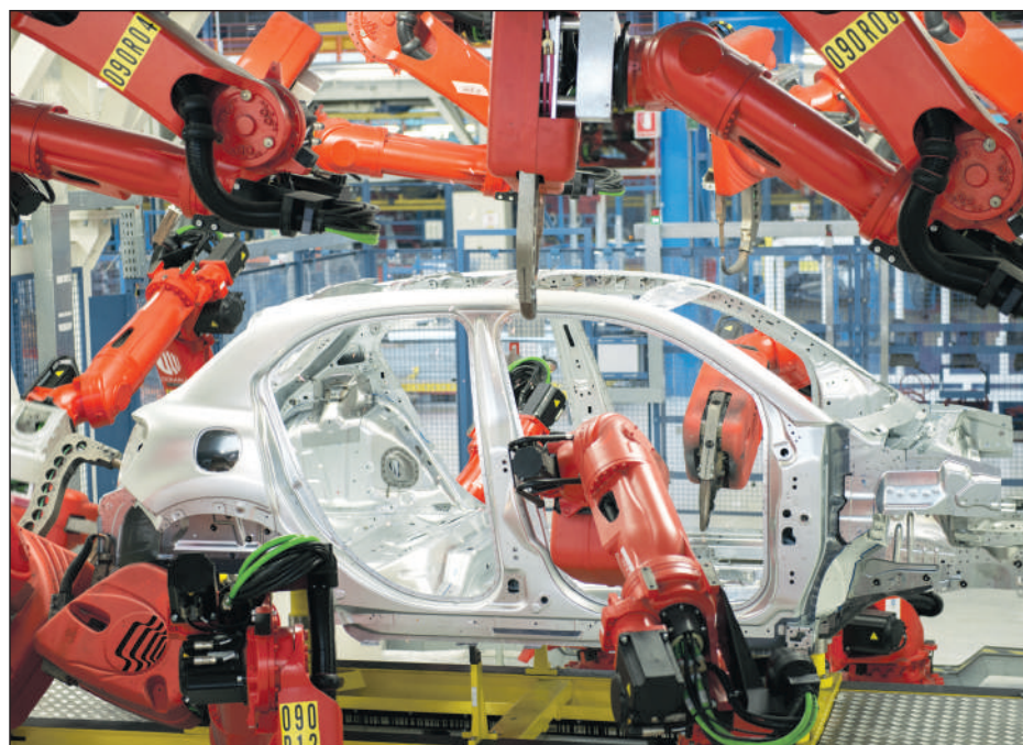
Après avoir été moulée, la coque de la 500X subit dans cette étape l'opération d'assemblage avec le concours d'une multitude de robots (Ph. FCA)
