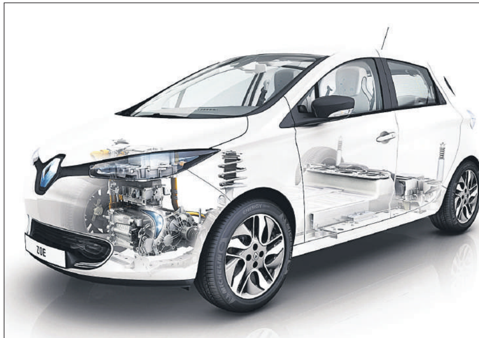
La Zoe, la première citadine électrique à rouler dans les rues marocaines. Sans roue de secours, elle exploite l'espace libre pour loger une plus grosse batterie (Ph. Renault)
